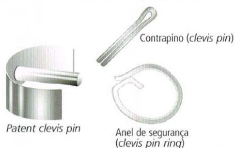
pinos, tornando mais fácil abrir e travar os parafusos de regulagem. Além disso, eles têm formato adequado e se amoldam suavemente aos parafusos, de forma que as velas, escotas e tecidos não são danificados por eles.
