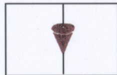
Regra 25 (e) EMBARCAÇÃO NAVEGANDO A VELA QUANDO TAMBÉM USANDO SUA PROPULSÃO MECÂNICA
