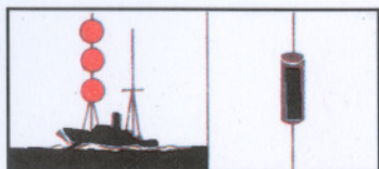
Regra 28 EMBARCAÇÃO RESTRITA DEVIDO AO SEU CALADO [ Além das luzes prescritas na Regra 23 (a) ]
