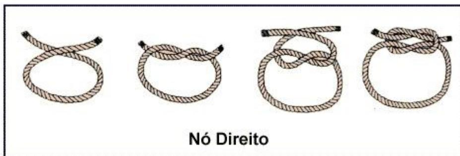
**Nó Direito** - O Nó Direito é útil para amarrar a vela grande na operação de rizo ou qualquer outro objeto a um ponto fixo no barco e para emendar cabos. Para dar esse nó, siga as ilustrações da esquerda para a direita.
