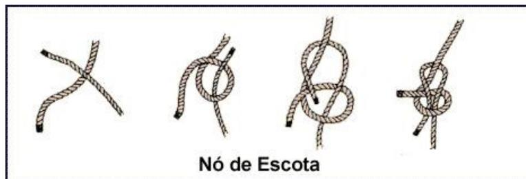
**Nó de Escota** - Este nó é usado para emendar dois cabos. Ele deve ser usado com cabos de diâmetros parecidos. Quando for usado com cabos de diâmetros muito diferentes devemos dar um cote adicional, transformando-o em nó de escota dobrado. Para dar esse nó, siga as ilustrações da esquerda para a direita.
